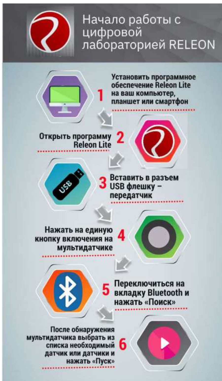
Рис. 14. Алгоритм работы с программным обеспечением Releon Lite
